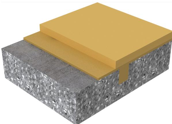
**Juntas de Expansión** - Deben ser colocadas en los sustratos en la intersección de materiales disímiles. Aísle las áreas sujetas a fuerzas térmicas, movimientos vibratorios o alrededor de columnas portantes y en anillos selladores de recipientes. Cuando las losas de concreto son nuevas se deben respetar todas las juntas (de construcción ó de movimiento).
